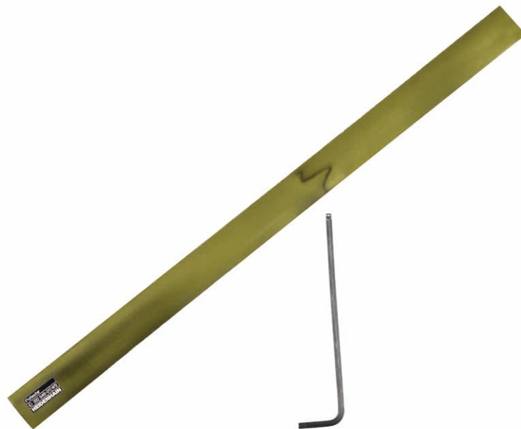
接触内六角扳手后，测试膜上标记可见，表示工具磁化
